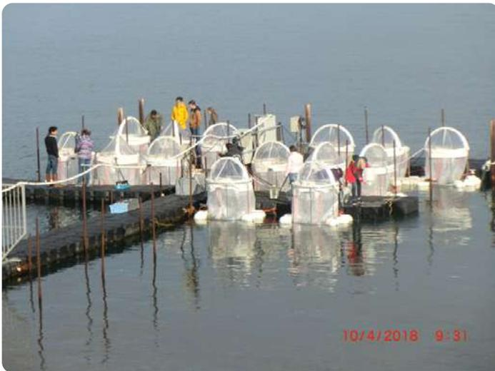
**Figure 6.8.** Mésocosmes dans la lagune de Thau (plateforme MEDIMEER, OSU-OREME Sète).
